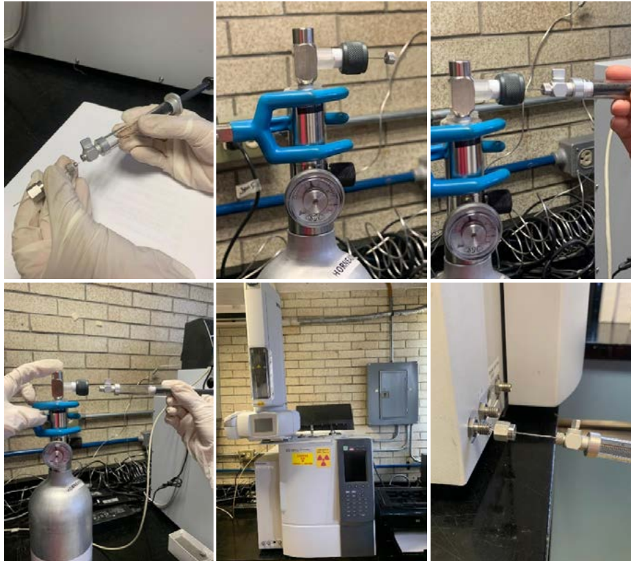
Figura 1. Procedimiento de toma de estándar de N_2O de 50.8 \mu\text{mol/mol} en un cilindro con regulador de septa e inyección al cromatógrafo.
