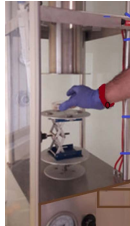
Figura 2. Una sección de la Torre de Potter para aspersión de sustancias, en este caso para M. anisopliae .
