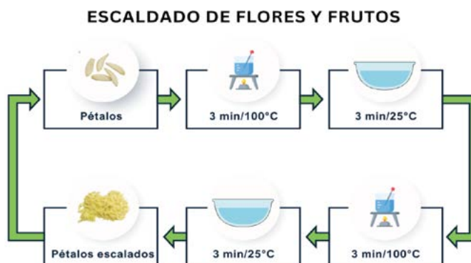
Figura 3. Diagrama del proceso de escaldado de flores y frutos de Yucca como pretratamiento. Fuente: Ángel M. Rodríguez-Rentería.
