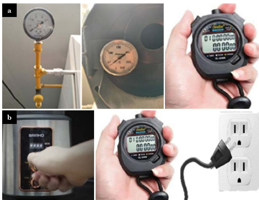
Figura 4. Seguimiento a las emisiones de GEI generadas por cada tostador, Monitoreo y registro de datos del consumo de energía a) del tostador de gas LP y b) del tostador eléctrico.
