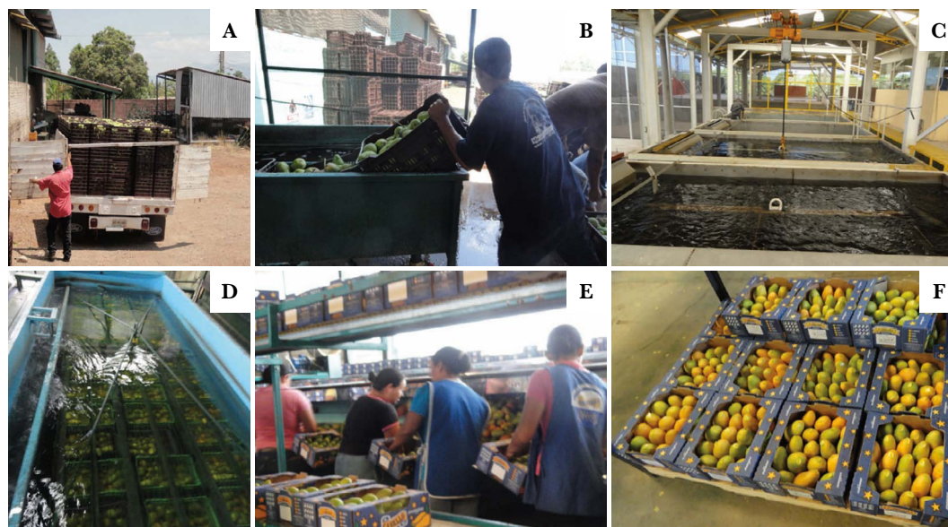
Figura 1. Etapas de manejo postcosecha de mango ‘Ataulfo’ de exportación: a) Recepción; b) Lavado; c) Tina de tratamiento hidrotérmico; d) Inmersión de frutos en tratamiento hidrotérmico; e) Selección y empaque; f) fruto empacado.
