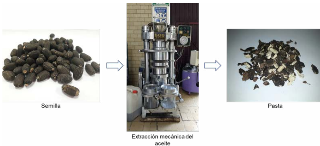
Figura 1. Proceso de extracción mecánica de aceite de Jatropha curcas L. var. Sevangel posterior a su cosecha y secado de la semilla. El residuo posterior se le denomina pasta.
